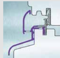
Volumschiene thermisch getrennt mit Federsteg mit Flügelfalz
