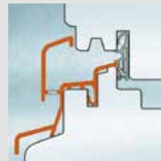
Verbundschiene mit Federsteg mit Flügelfalz
