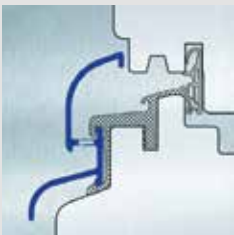
Verbundschiene thermisch getrennt mit Federsteg mit Flügelfalz
